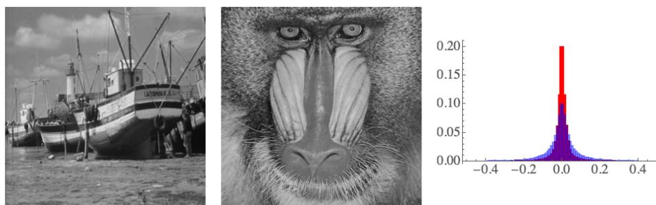
FIGURE 58 – A gauche et milieu deux images. A droite, en rouge l'histogramme normalisé des coefficients d'ondelettes (de détails seulement) pour l'image du bateau, en bleu pour celle du singe montrant plus de textures.
