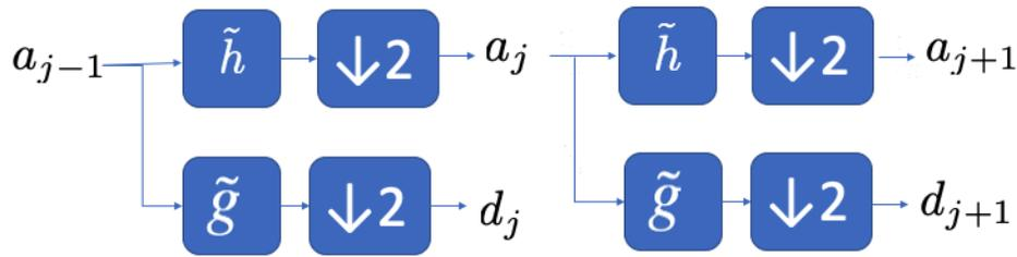
FIGURE 47 – A partir des coefficients d’approximation  $a_{j-1}$ , on obtient les coefficients d’approximation  $a_j$  et de détails  $d_j$  (Eqs. 219, 221). Puis, on peut cascader l’algorithme à partir des  $a_j$ , et ainsi de suite.
