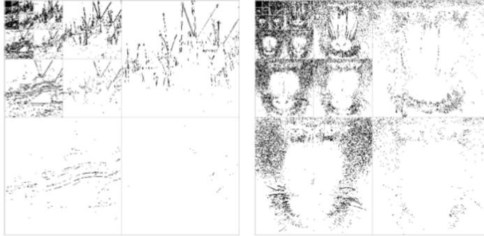
FIGURE 59 – Pour les deux images de la figure 58, on a procédé à la binarisation Eq. 262 avec les paramètres  $a = 5$  et  $p = 15$  du quantificateur Eq. 261 (nb. la distribution des coefficients de détails ont des queues assez longues). Les coefficients dont le résultat est 0 apparaissent en blanc sur les images. La décomposition en ondelettes est effectuée avec "Db2".
