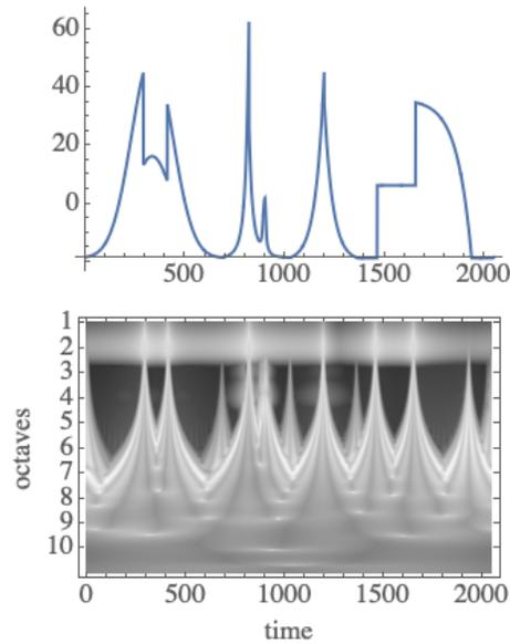
FIGURE 27 – Exemple de Scalogramme (bas) issu de la transformation en ondelettes du signal du schéma en haut. En abscisse la variable  $u$  (ex. temps), en ordonnée l'échelle  $s = s_0 2^j 2^{n/Q}$  avec  $j$  l'octave,  $n$  la "voix" et  $Q = 16$  le nombre de voix par octave, et  $s_0$  la plus petite échelle de l'ondelette. L'intensité des gris donne la valeur de  $|\log(W_x(v, s))|$  sur une échelle où 1 correspond au noir et 0 au blanc.
