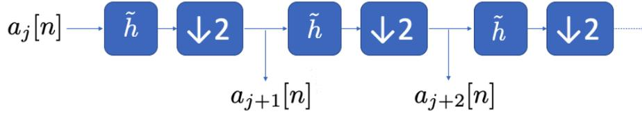
FIGURE 42 – Algorithme du passage des  $a_j[n]$  aux  $a_{j+1}[n]$ : cascade d’un filtre discret  $\tilde{h}$  passe-bas suivi d’un sous-échantillonnage d’un facteur 2. On peut noter les similitudes et différences par rapport à l’algorithme de Burt de la figure 41.
