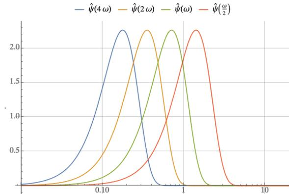
FIGURE 30 – Illustration de l'évolution du support du filtre passe-bande donné par  $\hat{\psi}(2^j\omega)$ : pour  $s = 2^j > 1$  le support se déplace vers les basses fréquences, et pour  $s < 1$  le support se déplace vers les hautes fréquences.
