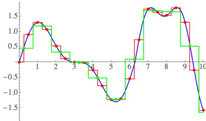
FIGURE 43 – Illustration de l’algorithme d’échantillonnage avec la fonction  $\phi(u)$  de Haar: premièrement on échantillonne le signal pour obtenir une approximation (rouge) sur une grille  $V_0$ , puis dans un second temps par filtrage-sous-échantillonnage on obtient une approximation sur une grille 2 fois plus large  $V_1$ .
