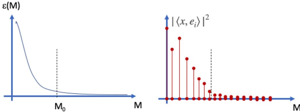
FIGURE 9 – (gauche): On aimerait que l'erreur de l'approximation (linéaire) puisse décroître suffisamment rapidement pour pouvoir mettre le seuil  $M_0$  assez bas. Cela se traduit par une contrainte sur l'énergie stockée dans les premiers coefficients (droite).
