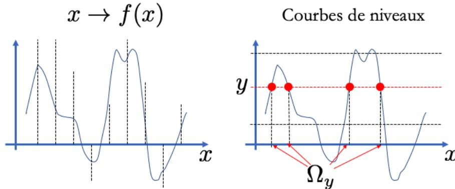
FIGURE 23 – Les deux points de vue du problème  $y = f(x)$ : soit on attaque le problème d'un point de vue où à chaque valeur de  $x$  on veut connaître  $f(x)$  un peu d'une manière indépendante du fait que  $x$  soit un signal pertinent (schéma de gauche), soit on étudie les courbes de niveau de  $f$  (schéma de droite) et on se concentre sur les valeurs de  $x$  qui comptent au final.
