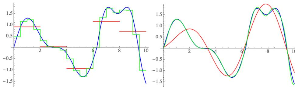
FIGURE 39 – Exemples d'analyse multirésolution avec  $\phi(u) = \mathbf{1}_{[0,1[}(u)$  (gauche) et  $\phi(u) = \text{sinc}(\pi u)$  (droite): en rouge  $j = 1$ , en vert  $j = -1$  et en bleu la fonction  $x(u)$ .
