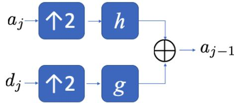
FIGURE 49 – A partir des coefficients  $a_j$  et  $d_j$ , on peut reconstruire les coefficients  $a_{j-1}$  suivant les formules Eqs. 224, 226, la dernière faisant apparaître le grossissement d'un facteur 2 des tailles des coefficients  $a_j$  et  $d_j$  par insertion de 0 avant le filtrage.
