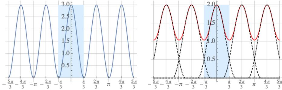
FIGURE 35 – Spectres de Fourier avec les réplifications tous les  $2k\pi/T$  avec à gauche un cas de figure où il n’y a pas d’aliasing, contrairement au cas de figure du schéma de droite (ici  $T = 3$ ). La bande de base est illustrée par le rectangle bleu.
