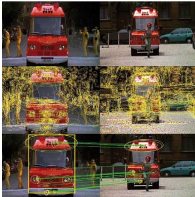
Fig. 2 : En haut, la même camionnette apparaît dans deux plans différents d'un film mais avec une localisation et un éclairage différents ainsi que la présence d'une femme sur une image de droite. Au centre, des primitives visuelles (ellipses) sont extraites de ces images. En bas, on voit le résultat de l'appariement automatique de ces primitives pour la recherche de la camionnette (désignée par le rectangle jaune) dans l'image de droite : l'ordinateur est capable d'identifier la camionnette à droite en dépit des différences précitées.
