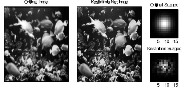
Şekil 1: Basit imge netleştirme örneği. En soldaki şekilde gözlemlenen bulanık imge ( X ), ortaki şekilde imge netleştirme modeli kullanılarak kestirilmiş net imge ( Z_1 ), sağdaki şekillerde ise bulanık imgeyi elde etmek için kullanılmış süzgeç ile kestirim sonucu elde edilmiş süzgeç ( Z_2 ) bulunmaktadır.
