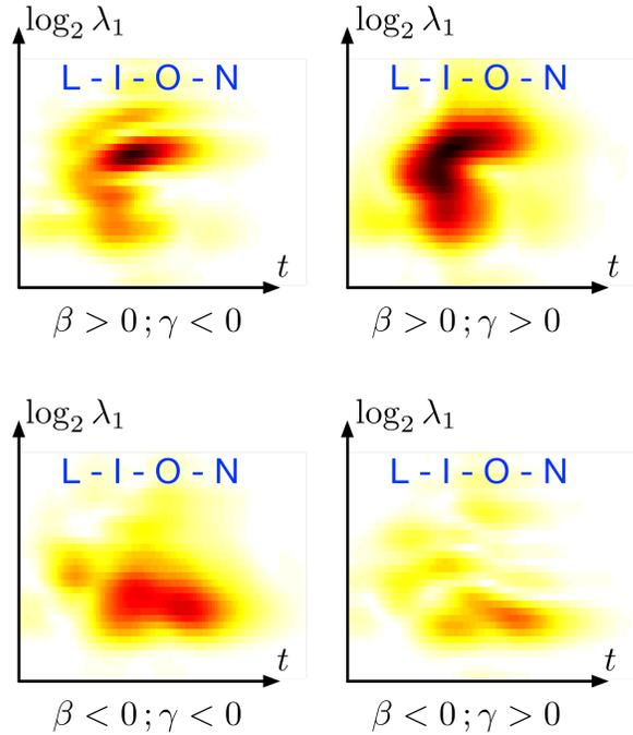
FIGURE 3 – En haut, un scalogramme  $x_1(t, \log_2 \lambda_1)$  du mot anglais *lion* (prononcé /laɪən/). En bas, coefficients de scattering de  $x_2(t, \log_2 \lambda_1, \log_2 \lambda_2)$  en fonction du temps  $t$  et de la log-fréquence  $\log_2 \lambda_1$ , pour  $\lambda_2 = (\alpha, \beta, \gamma)$  fixé avec  $\alpha^{-1} = 120$  ms,  $\beta^{-1} = \pm 1$  octave,  $\gamma^{-1} = \pm 4$  octaves. La clarté est inversement proportionnelle à l'amplitude des coefficients.
