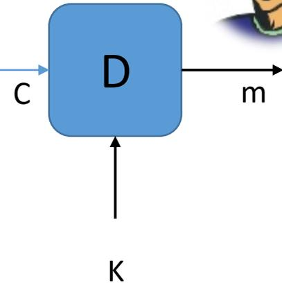
E (Fonction de chiffrement) et D (Fonction de déchiffrement): Fonctions inversibles et efficaces
