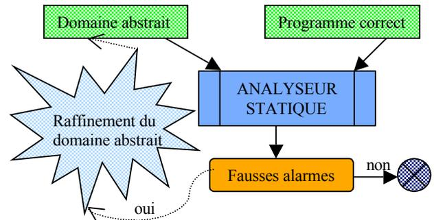
Deuxième phase : l'utilisateur final prouve l'absence d'erreurs à l'exécution de nouveaux logiciels de la famille par **paramétrisation de l'analyseur statique adaptatif** :
