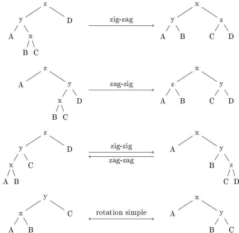
Après *chaque* opération RECHERCHER( $T, x$ ), INSÉRER( $T, x$ ), SUPPRIMER( $T, x$ ), ..., on remonte  $x$  vers la racine par un splay. L’arbre peut donc être modifié par RECHERCHER, ce qui est inhabituel. On impose que si RECHERCHER( $T, x$ ) renvoie “Faux”, alors l’opération splay est appliquée au dernier noeud visité.
